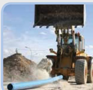
Nakon udarca kamena od 500 kg ispuštenog s visine od 3 metra cijev TOM<sup>®</sup> potpuno je neoštećena.
